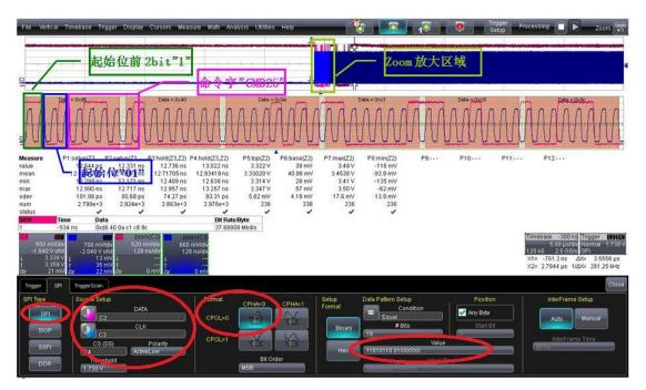
以上针对 I2C 和 SD-card 的测试需要用到示波器的 "I2C 触发"和"SPI 触发"方式,所以选择一款具备该功能的示波器是必要的,鼎阳科技的 SDS3000X 系列示波器配置了丰富的触发和解码功能,在相关测试中得心应手。
