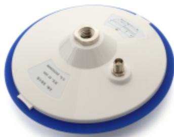
可以发射 GPS、GLONASS 和北斗频段的信号，天线具有高增益，良好的低仰角增益、广角圆极化和稳定的相位中心等特点。适用于多系统、高精度测绘领域，可配套卫星信号转发设备进行卫星信号发射。
