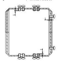
产品分两部分固定,前端模块底面上4个M4.5螺孔,后端模块底面有4个M4.5螺孔,具体尺寸请参见上文结构尺寸图。
