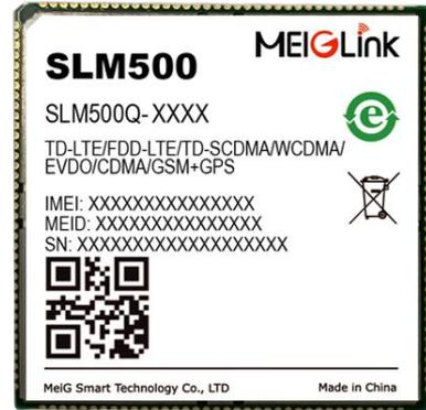
SLM500Q 系列核心板，采用高通骁龙 200 系列的 QCM2150，该 CPU 采用 28nm FinFET 制程，内置 64bit ARM、4 核 A53 (4\*1.3GHz)，支持 Decode/encode 最高 1080P@30fps、H.264，支持 HD+ 屏幕分辨率，支持两路 ISP 摄像头，搭载 Android 10 操作系统，支持板卡内存为 1GB+8GB (2GB+16GB、3GB+32GB)，支持 LTE Cat4，最大下行速率可达 150Mbps，最大上行速率可达 50Mbps。支持 TD-LTE/FDD-LTE/WCDMA/EVDO/TD-SCDMA/CDMA/GSM 多种网络制式，集成了 GNSS 和 2.4&5G WIFI 的宽带智能无线通信模块。
