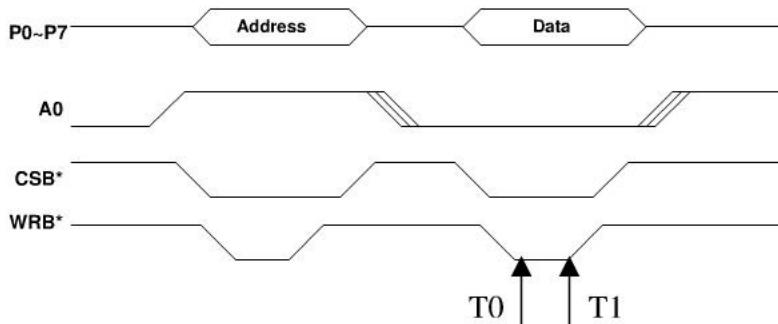
在图中，标出了“T0” 和 “T1” 二个时间点。对于写 0x37 寄存器，在 T0 时间点的时候，由于已经确定了是写 0x37 寄存器，所以就将芯片内部唤醒并开始语音识别流程；而在 T1 时间点，数据才会随同上跳沿拿进来。对其他寄存器，只是为了设置寄存器的值，这个长度没有什么关系。而对于 0x37 寄存器的双重功能来说，这个时间长度太长就会带来时序上的错误。
